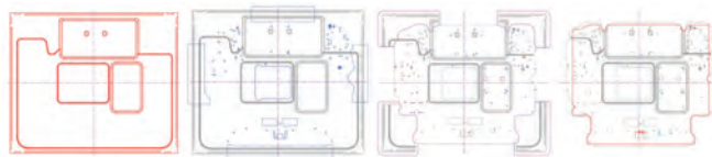
第一序 拉延 第二序 修边 第三序 切边 第四序 折弯
