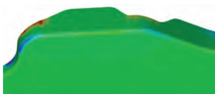
图 7 优化后折弯工艺仿真结果
